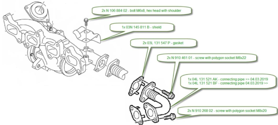
**El kit de sustitución 227200 contiene todas las piezas necesarias cuando sustituimos el turbo 830324-todos por el 873732-5001S**
