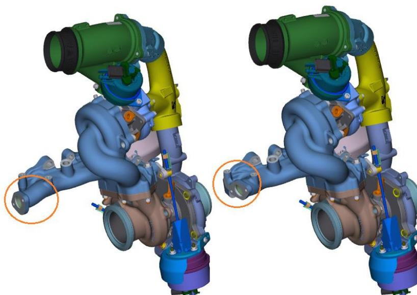
Estos dos turbos usan un tubo de conexión a la válvula EGR y un protector de calor diferentes:
