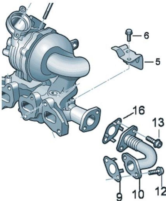
***El kit de sustitución 227200 contiene todas las piezas necesarias cuando sustituimos el turbo las referencias antiguas señaladas en la tabla de arriba por el turbo 1000-988-0383***
