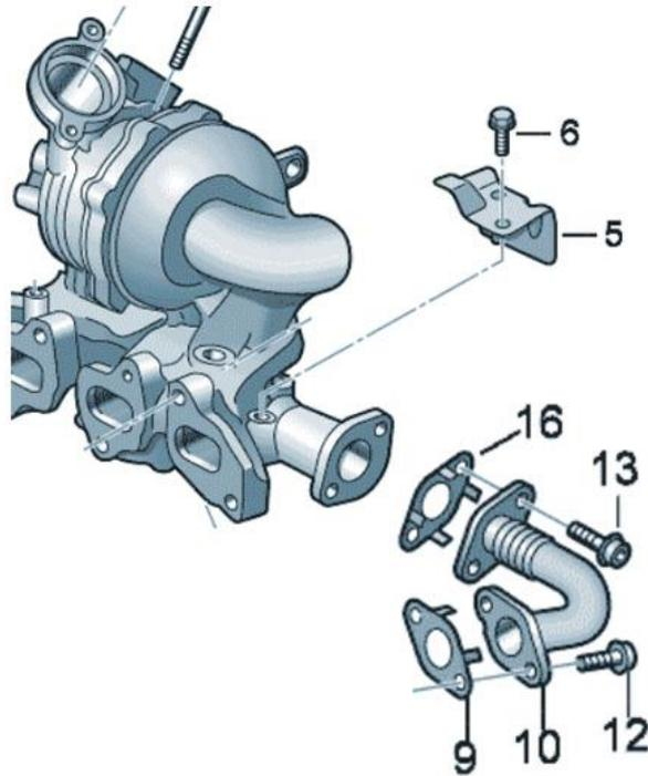
***El kit de sustitución 227204 contiene todas las piezas necesarias cuando sustituimos el turbo las referencias antiguas señaladas en la tabla de arriba por el turbo 1000-988-0384***
